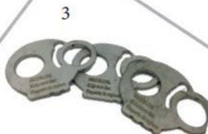
Démonstration de l'utilisation d'une plaquette de rupture Conçues pour les tests à 600daN, 1200daN et 2000daN.
