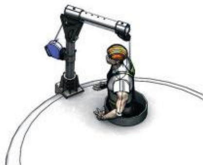
Potence avec interface soudée
