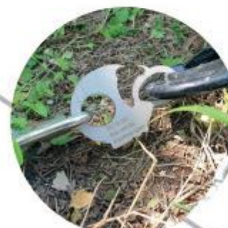
Démonstration de l'utilisation d'une plaquette de rupture Conçues pour les tests à 600daN, 1200daN et 2000daN.
