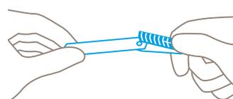
Soulevez le curseur, retirez et changez la lame. La perforation de la lame doit être **placée exactement sur l'ergot**. Les gauchers tournent la lame de 180°. Les deux aimants vont maintenir additionnellement la lame.
